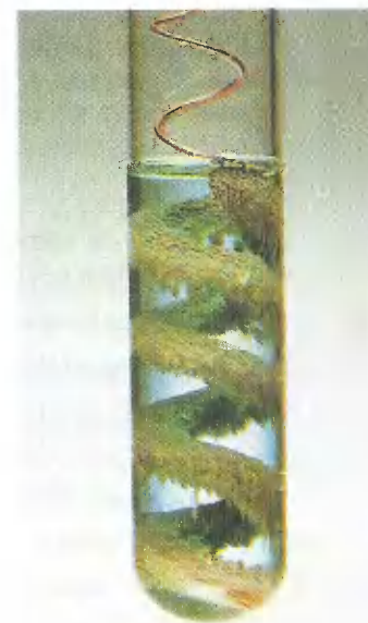
Рис. 104. Кристаллы серебра, выделившиеся на медной проволоке в результате реакции замещения меди в растворе нитрата серебра
