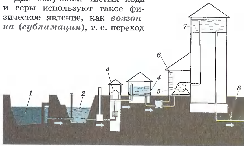
Рис. 84. Схема водоочистительной станции: 1 — река; 2 — бассейн для отстаивания воды; 3 — колодец; 4 — фильтр; 5 — главный насос; 6 — устройство для хлорирования воды; 7 — водонапорная башня; 8 — водопровод в город
